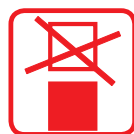
NE PAS EMPIILER
